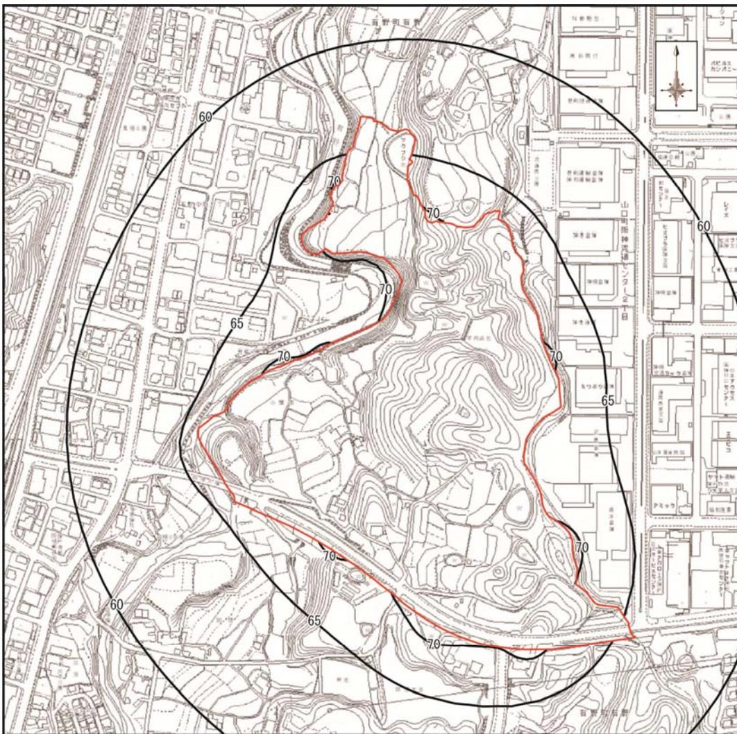
図3.2.3 建設機械の稼働に伴う騒音レベル (L<sub>A5</sub>) の予測結果
